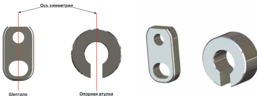
▲ | Две детали — шептало и опорная втулка выполнены симметричными
